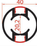
Ø40 İki Kapaklı Dikme Profil No: 690668 /3 Ağırlık: 1,031 Kg/m
