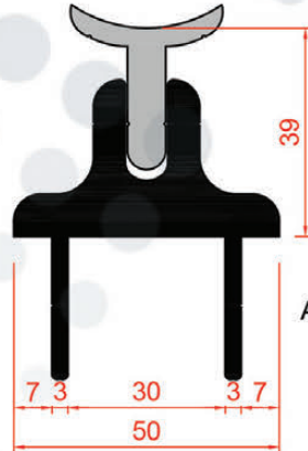
Ezber Bozan Hareketli Mafsal Adet / TL Ağırlık: 2,320 kg/m
