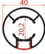
Ø40 Tek Kapaklı Dikme Profil No: 1006216 /3 Ağırlık: 0,826 Kg/m
