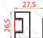
Kapaksız Yatay Taşıyıcı Profil No: 1006300 /3 Ağırlık: 0,435 Kg/m
