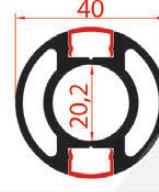
Ø40 İki Kapaklı Dikme Profil No: 260601 /3 Ağırlık: 1,240 Kg/m
