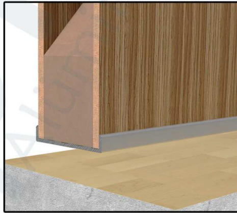
D78_U DÜZ ÇERÇEVELİ LAMİNAT KANAT ZEMİN DETAYI
