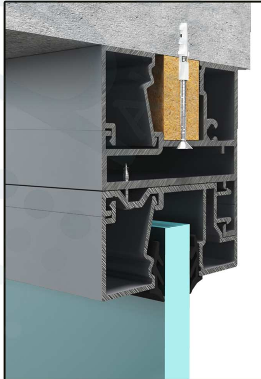
D46_KANAT ÜSTÜ - SABİT CAM DETAYI 3 - DİKEY KESİT
