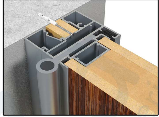
D56_KAPI KASA + ÇİFT TARAFLI AHŞAP KANAT DETAYI
