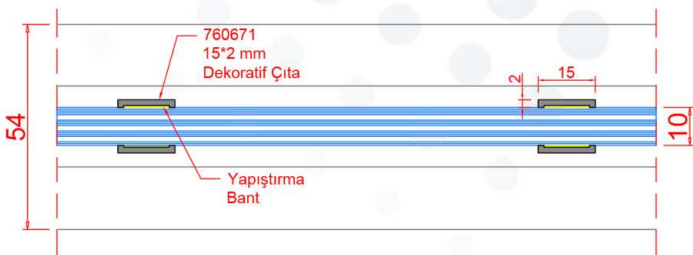
D101_15 x 2 MM DEKORATİF ÇITA PROFİL UYGULAMA DETAYI
