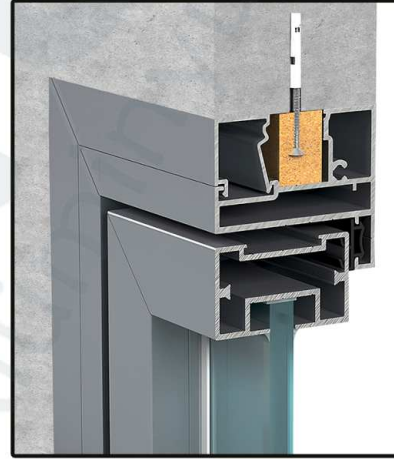
D28_TAVAN KAPI KASA + DÜZ CAM KANAT DETAYI
