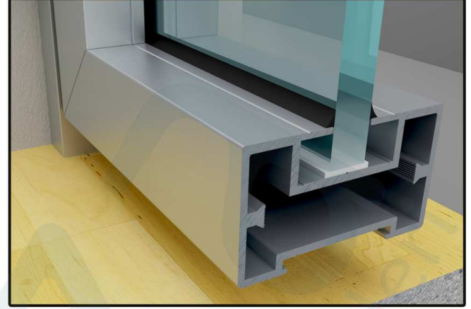
D30_DÜZ CAM KANAT ZEMİN DETAYI
