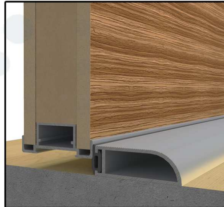
D63-3_ÇİFT TARAFLI AHŞAP KANAT, EŞİK PROFİLİ DETAYI
