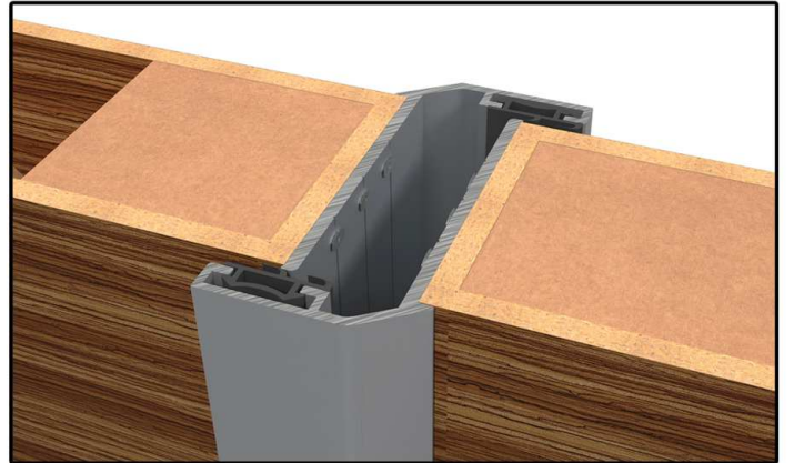
D71_LAMİNANT KANAT, ÇİFT KANAT DETAYI
