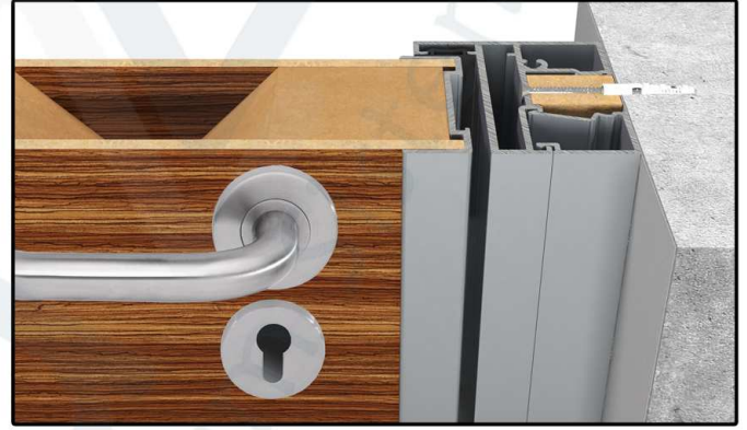
D81_U KANALLI ÇERÇEVELİ LAMİNAT KANAT + KAPI KASA DETAYI
