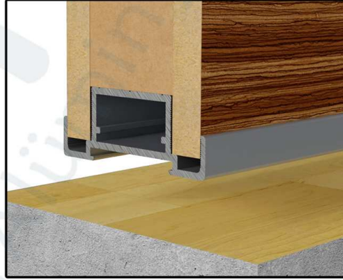
D62_ÇİFT TARAFLI AHŞAP KANAT ZEMİN DETAYI
