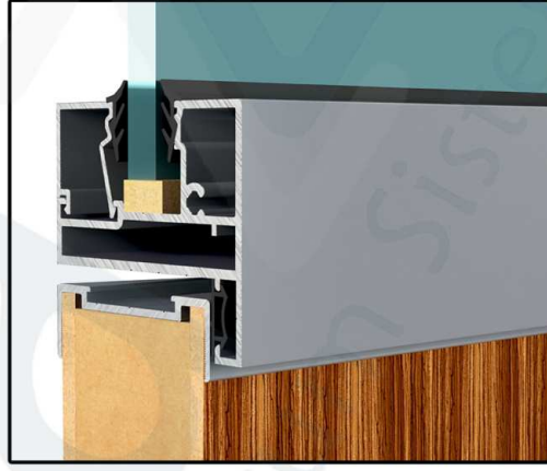
D85_U KANALLI ÇERÇEVELİ LAMİNAT KANAT ÜSTÜ + KAPI KASA DETAYI
