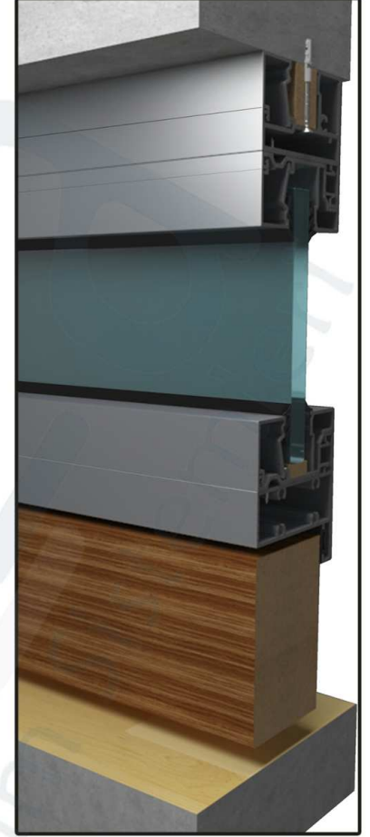
D47-1_KANAT ÜSTÜ, T PROFİLİ VE ADAPTÖRLÜ - SABİT CAM DETAYI - DİKEY KESİT
