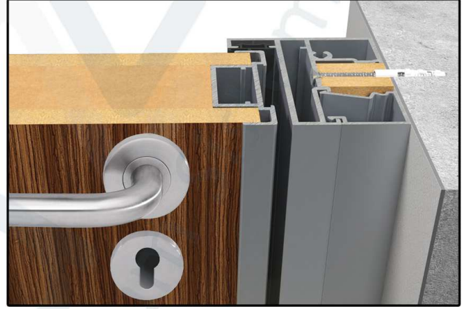
D57_ÇİFT TARAFLI AHŞAP KANAT + KAPI KASA DETAYI
