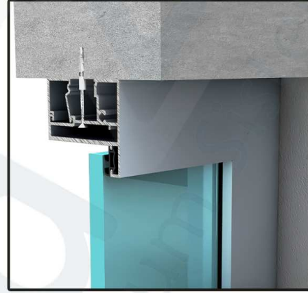
D10_TAVAN + 10 MM CAM KANAT DETAYI
