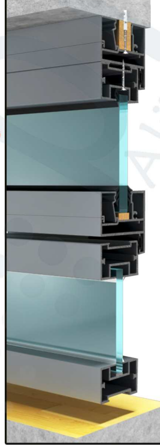
D43_KANAT ÜSTÜ - SABİT CAM DETAYI 2 - DİKEY KESİT
