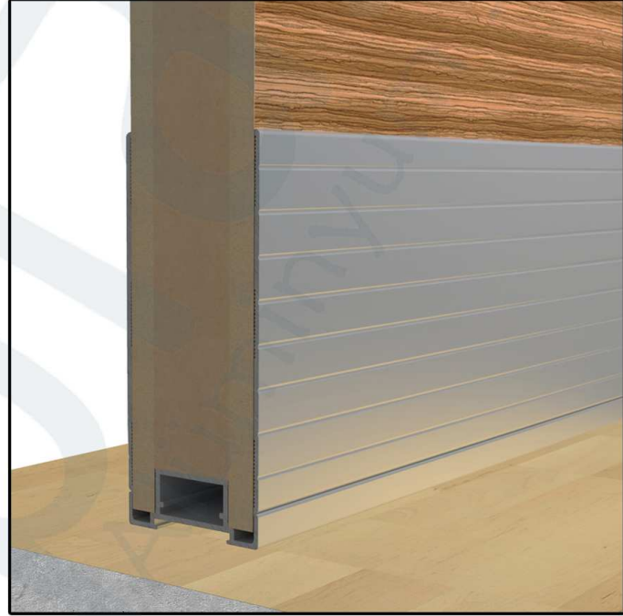
D63-2_ÇİFT TARAFLI AHŞAP KANAT, 100 MM TEKMELİK PROFİLİ DETAYI
