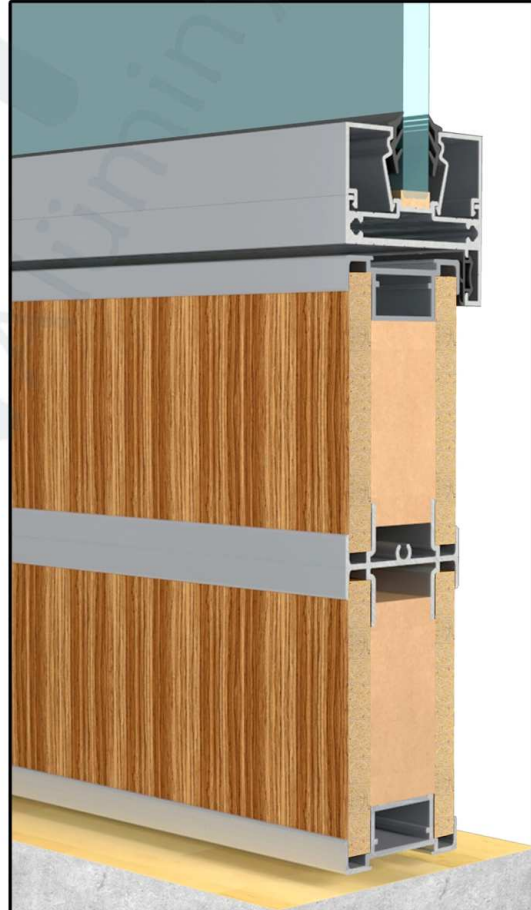
D97_ÇİFT TARAFLI AHŞAP KANAT, ORTA KAYIT DETAYI
