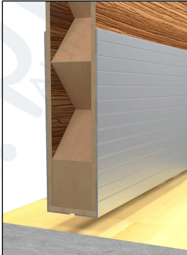
D71-2_LAMİNAT KANAT, 150 MM TEKMELİK DETAYI
