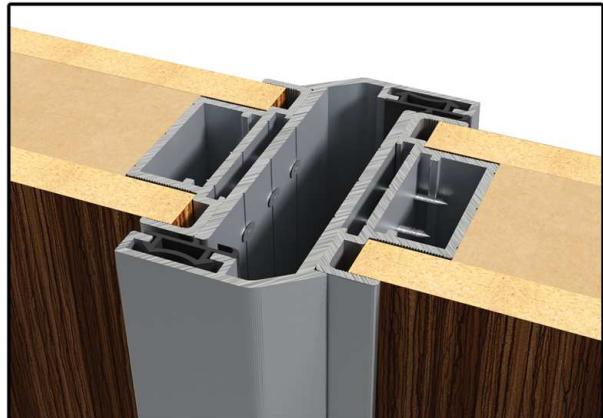
D63_ÇİFT TARAFLI AHŞAP KANAT, ÇİFT KANAT DETAYI
