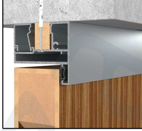
D68_TAVAN KAPI KASA + LAMİNANT KANAT DETAYI
