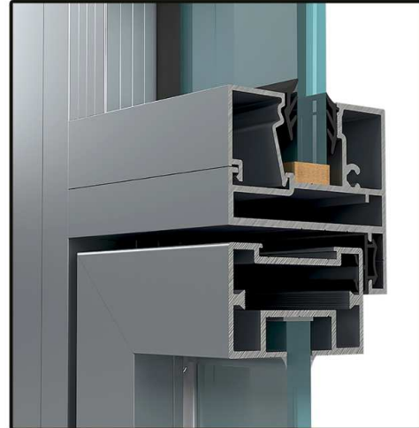
D29_DÜZ CAM KANAT ÜSTÜ + KAPI KASA DETAYI
