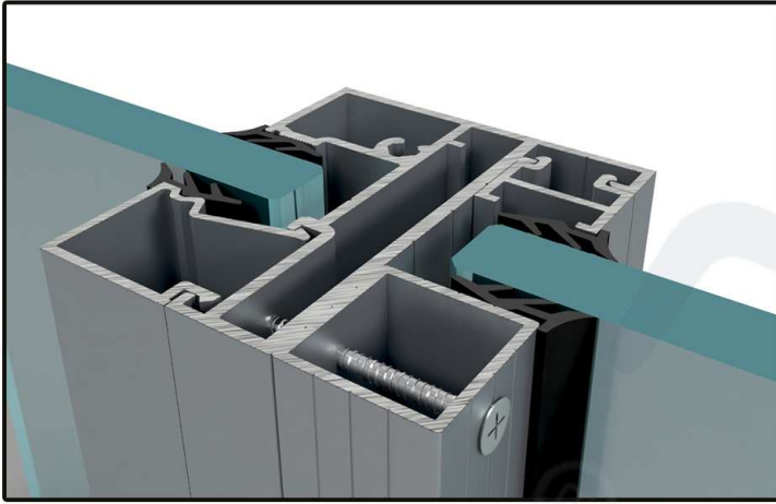
D40_KANAT ÜSTÜ - SABİT CAM DETAYI 1 - YATAY KESİT
