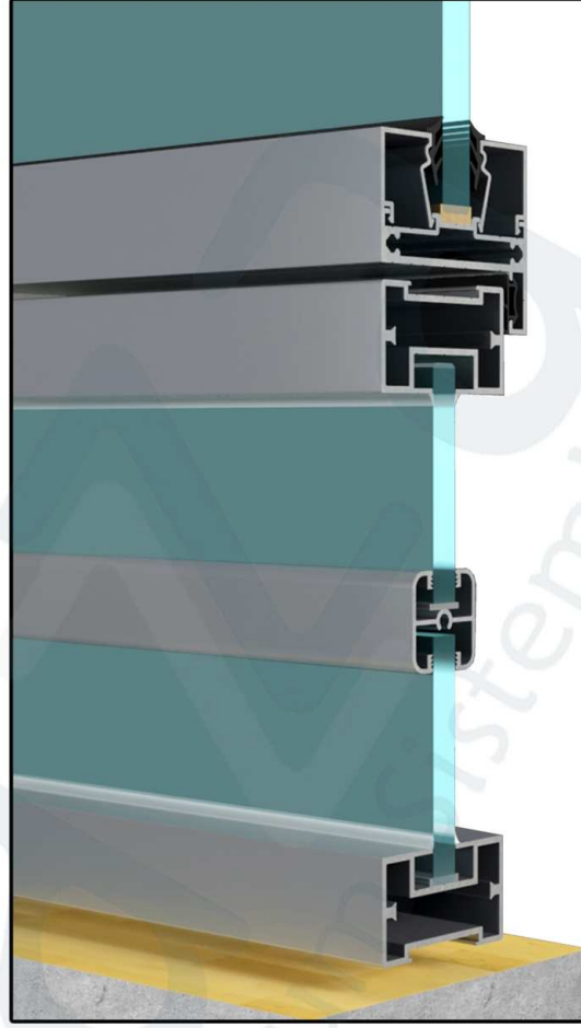
D96_DÜZ CAM KANAT, ORTA KAYIT DETAYI
