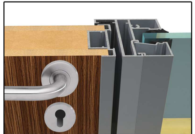
D59_ÇİFT TARAFLI AHŞAP KANAT + SABİT CAMLI KAPI KASA DETAYI
