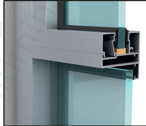
D11_10 MM CAM KANAT ÜSTÜ + SABİT CAM DETAYI
