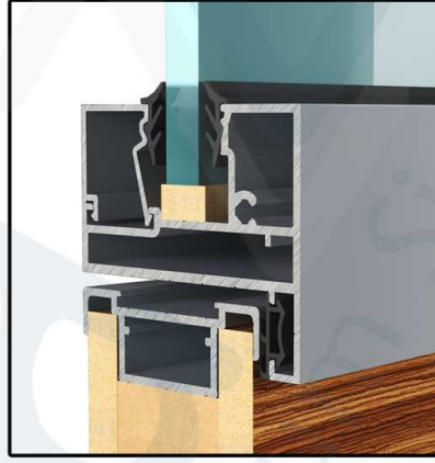
D61_ÇİFT TARAFLI AHŞAP KANAT ÜSTÜ + KAPI KASA DETAYI
