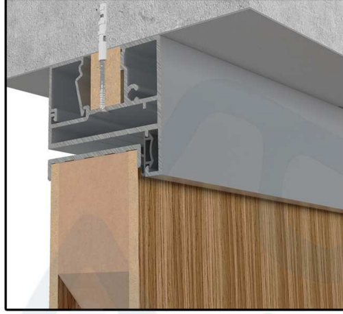
D76_TAVAN KAPI KASA + U DÜZ ÇERÇEVELİ LAMİNAT KANAT DETAYI
