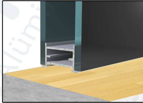
D94_ÇİFT YÜZ CAM KANAT ZEMİN DETAYI
