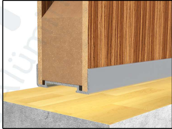
D86_U KANALLI ÇERÇEVELİ LAMİNAT KANAT ZEMİN DETAYI
