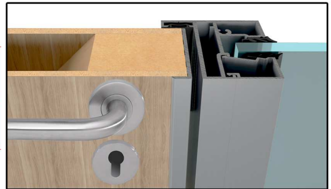
D75_U DÜZ ÇERÇEVELİ LAMİNAT KANAT + SABİT CAMLI KAPI KASA DETAYI
