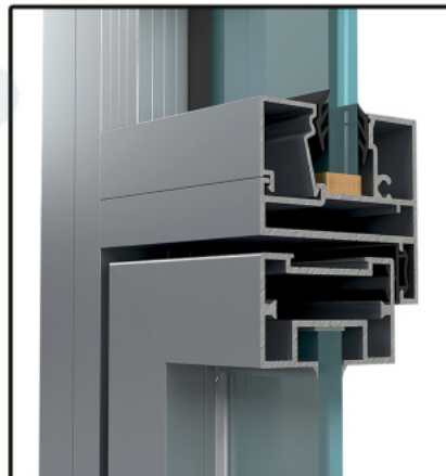
D37_KANAT ÜSTÜ - SABİT CAM DETAYI 1 - DİKEY KESİT
