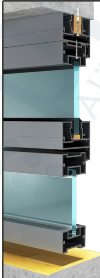
D39_KANAT ÜSTÜ - SABİT CAM DETAYI 2 - DİKEY KESİT
