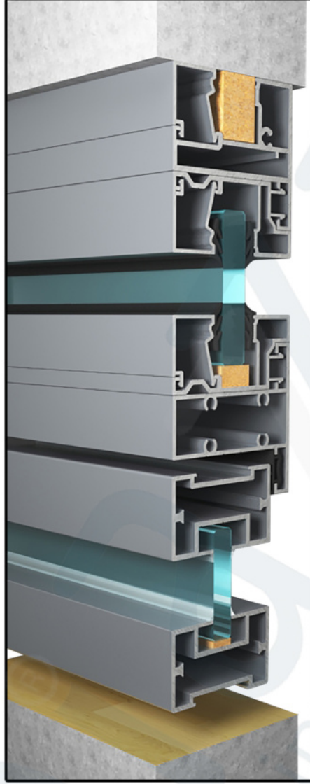
D43_KANAT ÜSTÜ, T PROFİLİ VE ADAPTÖRLÜ - SABİT CAM DETAYI - DİKEY KESİT
