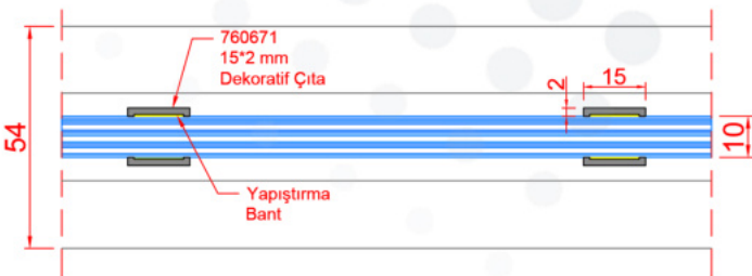
D68_15 x 2 MM DEKORATİF ÇİTA PROFİL UYGULAMA DETAYI
